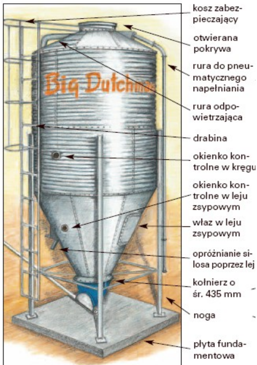
Rysunek nr 3.2.2-2 Poglądowa konstrukcja silosu firmy Big-Dutchman
