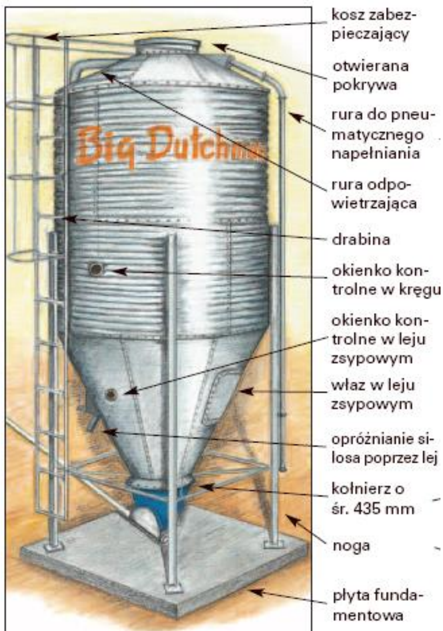
Rysunek nr 3.2.2-2 Poglądowa konstrukcja silosu firmy Big-Dutchman
